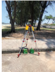
รูปที่ 17 การติดตั้ง GPS.BASE STATION
